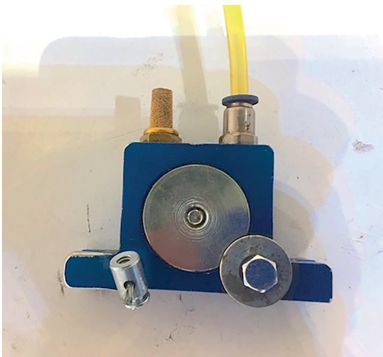
FIGURA 1. Vibrador neumático rotativo, OLI S10. Véase https://www.olivibra.com/products/s-rotary-pneumatic-vibrators-ball/
